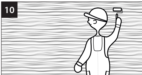
Vor dem Anstrich muss die Fläche mit Grundierungsmittel Weldprimer gleichmäßig grundiert werden. Bitte verwenden Sie hierzu eine Velourrolle.
